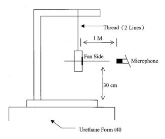
1 METER FROM MICROPHONE TO FAN INTAKE
