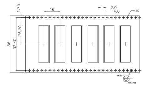
• Taping reel dimensions (mm)
