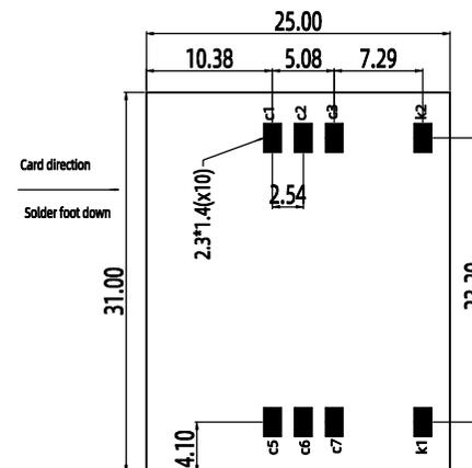
RECOMMENDED PCB LAYOUT NO TOLERANCE±0.05
