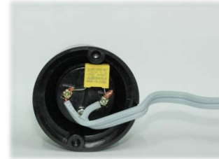
ลักษณะการต่อที่ขั้ว L และ N ที่เต้าของหลอดไฟ
