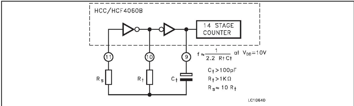
TYPICAL CRYSTAL OSCILLATOR CIRCUIT
