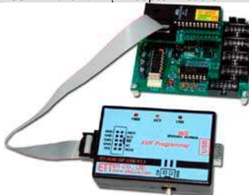
รูปที่ 2 การต่อ ET-AVR ISP USB v1 ใช้งานกับชุด Adapter Module
