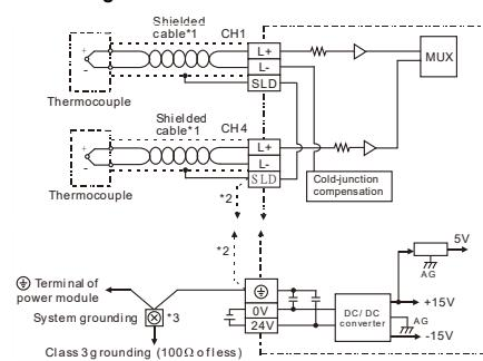
**Not 1:** Üründe giriş bağlantısı yaparken girişine bağlı termokuplı sıcaklık sensörünün orjinal kablosunu kullanınız. PLC terminal vidalarını 1.95 kg-cm (1.7 in-lbs) tork oranında sıkınız.
