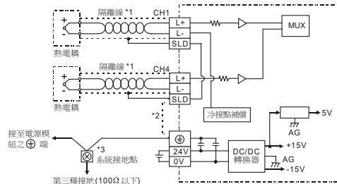
註1：使用於類比輸入的配線應採用 J, K, R, S, T 型熱電偶溫度感測器之連接線或隔離線，且應與其他電源線或可能引起雜訊之接線分開。端子螺絲扭力為  $1.95 \text{ kg-cm}$  ( $1.7 \text{ in-lbs}$ )。
